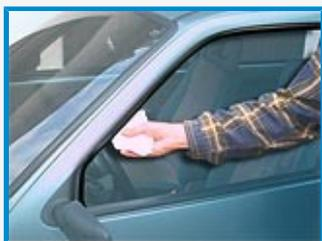
Die Fenster ganz öffnen und die Innenfläche der Fensterdichtungen mit Hilfe eines Lappens mit Antifettmittel säubern und danach trocknen lassen.
