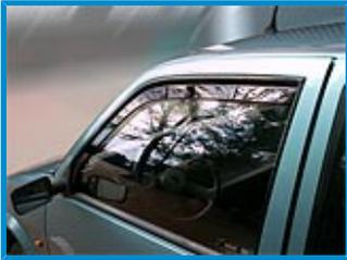
Nach der Montage das **Fenster langsam und ohne Gewalt schließen**. Die Fensterscheibe bitte über Nacht geschlossen halten, damit der Windabweiser durch den permanenten Andruck der Scheibe in die Gummis eingepresst wird.
